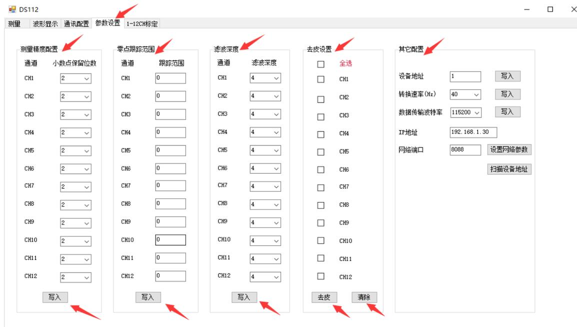
4) .“去皮设置”可将当前选择通道的传感器的状态显示归零。（选择要去皮的通道，点击“去皮”写入到模块（约等待 5 秒），点击“取消”即取消去皮状态。
