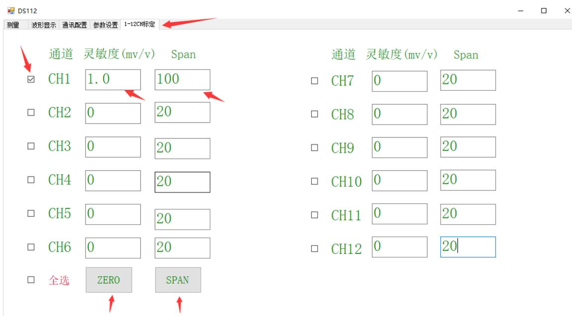
2. 若采集模块的显示值和实际的数值有差别，可通过下面的比例公式算出实际的灵敏度即可。
