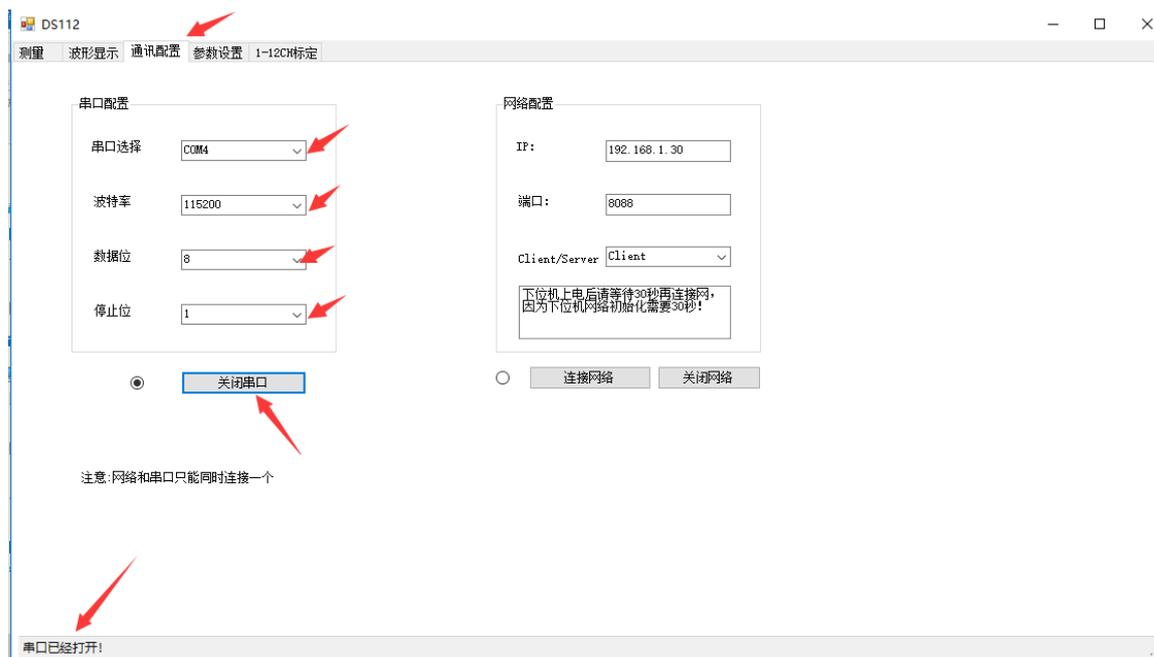
2) .点击“打开串口”等待约 3 秒，软件自动连接（软件左下角显示“串口已打开”此时采集模块的各项参数都已被上位机读取。）
